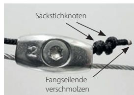
Fangseil mit Sackstichknoten und verschmolzener Schnitt nach der Seilklemme
