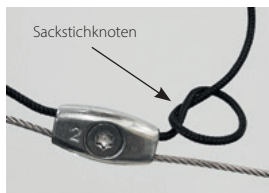
Fangseil mit Sackstichknoten und verschmolzener Schnitt nach der Seilklemme
